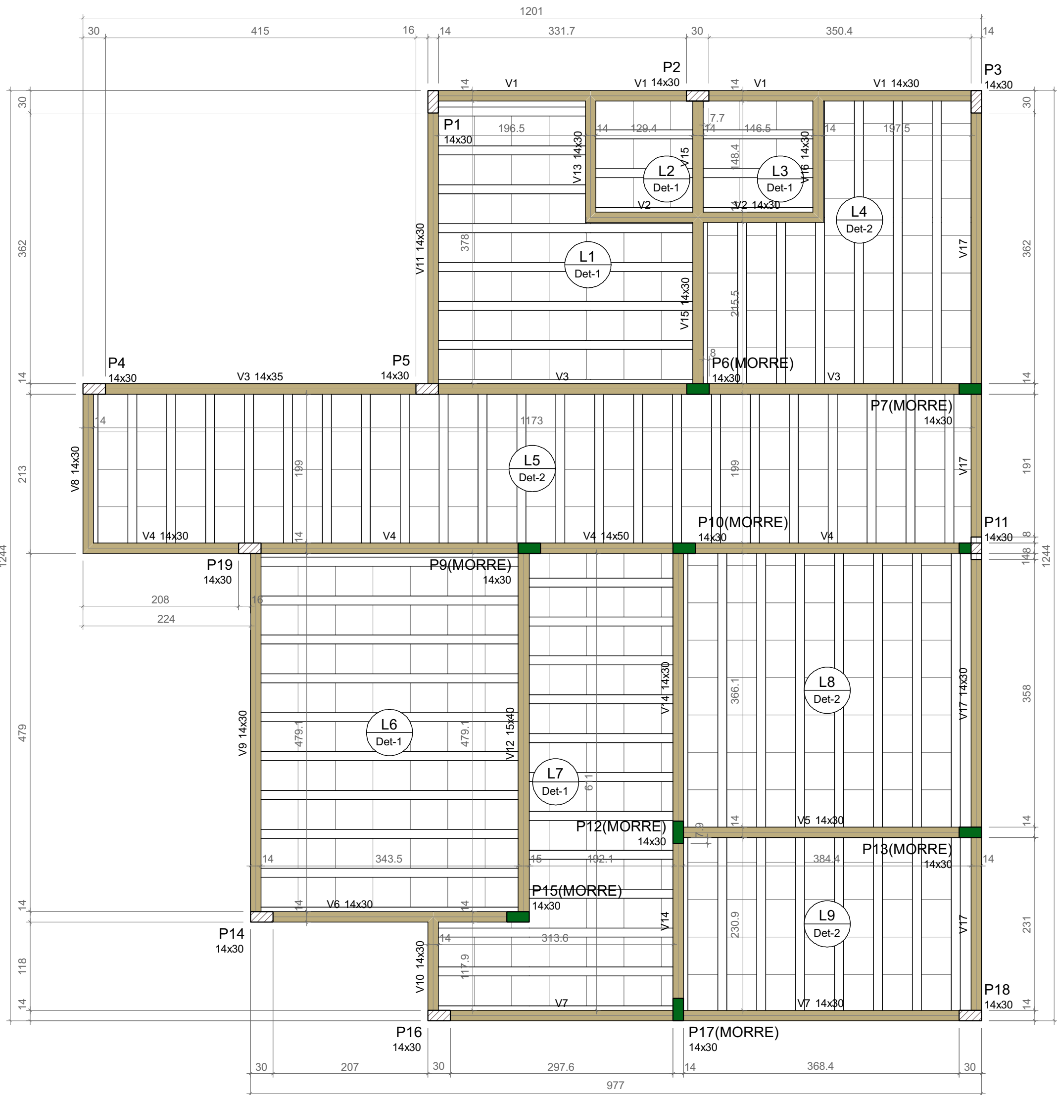
FORMA DO PAVIMENTO PLATIBANDA Escala 1:50
