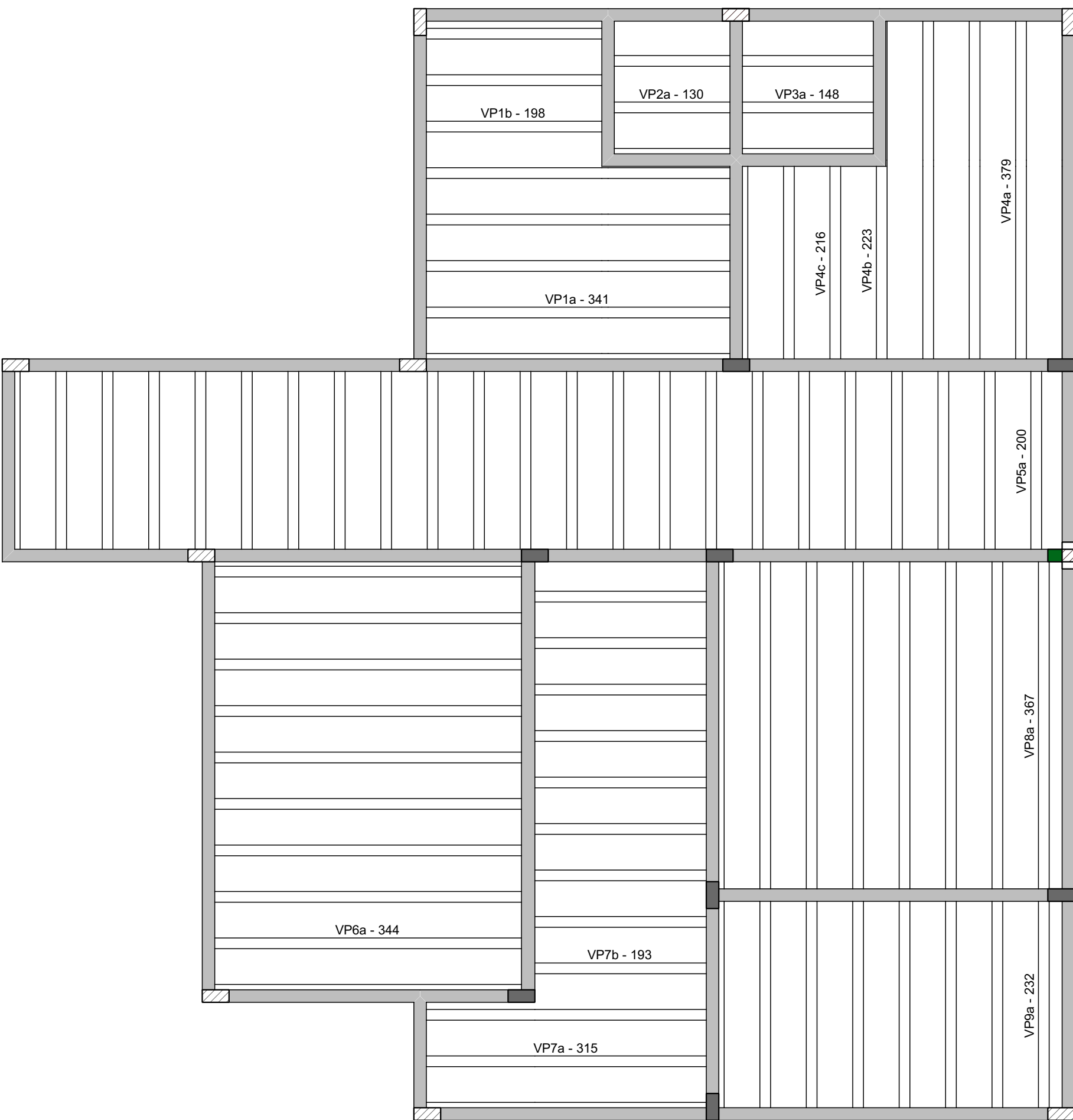
PLANTA DE VIGOTAS PRÉ-MOLDADAS
