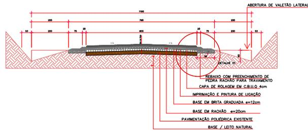
SEÇÃO TRANSVERSAL TIPO ATERRO COM ABERTURA DE VALETÃO LATERAL
